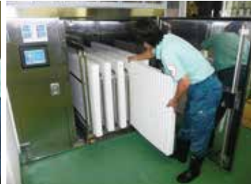
専用洗浄機プラス医療用具許可番号取得の専用消毒機の四重システム ※四重システム：温水洗浄＋加熱蒸気＋抗菌処理＋高温加熱処理
