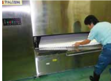
専用洗浄機プラス医療用具許可番号取得の専用消毒機の四重システム ※四重システム：温水洗浄＋加熱蒸気＋抗菌処理＋高温加熱処理
