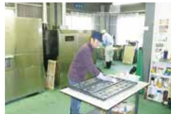
機械作業が困難なものは、手作業で丁寧に清拭・消毒を行い、更にUV・オゾン消毒を実施
